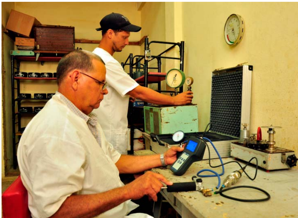
Los técnicos Hemberto Ortiz (primer plano) y José Antonio Salles, trabajan en el Laboratorio de Presión, para verificar y calibrar esfigmomanómetros y otros aditamentos.
