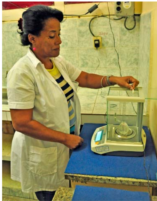
La especialista Eva Dorimon opera la balanza analítica en el Laboratorio de Volumen, donde se comprueban instrumentos de cristal.
