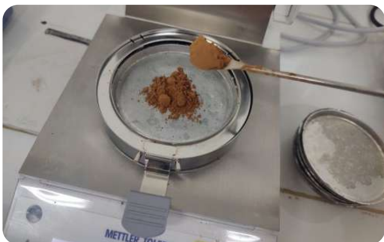
En el área del laboratorio químico, físico y sensorial se busca el porcentaje de humedad en una muestra de cocoa micropulverizada, que no debe superar el 7 por ciento.
