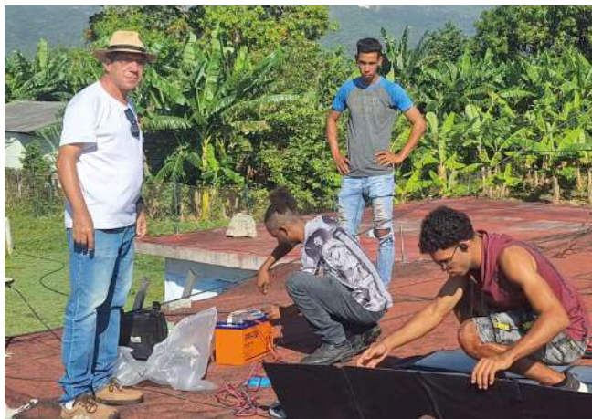
El equipo, liderado por el doctor Arango Arias (con sombrero) realiza mediciones en la provincia para determinar las deformaciones causadas por la actividad sísmica que comenzó el pasado 17 de marzo, con un terremoto de 6.0 de magnitud. La gráfica muestra la instalación del GNSS en el techo de la Estación meteorológica, situada en el Valle de Caujerí.
