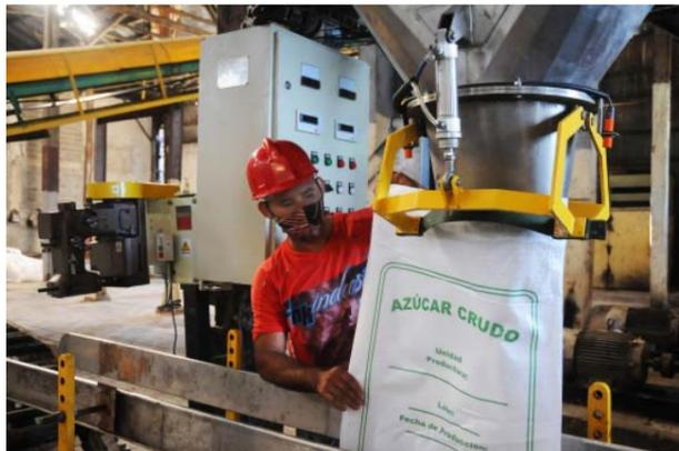
El montaje de una nueva ensacadora tributará al eficiente proceso de envasado, transportación y comercialización del crudo.
