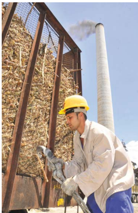
Tras la rotura del motor hidráulico del gúinche, hubo que regresar al método tradicional y trasladar los carros de la romana hasta el basculador tirados por un tractor.
